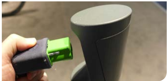
Abbildung 40: Prototyp einer Ladesäule mit neuem Ladestecker
