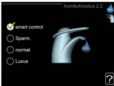
Der Unterschied zwischen den verfügbaren Modi besteht in der Brauchwassertemperatur. Bei einer höheren Temperatur steht mehr Brauchwasser zur Verfü-
