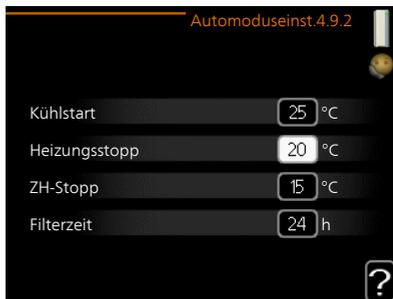
Wenn als Betriebsmodus "auto" eingestellt ist, bestimmt das Innenmodul ausgehend von der mittleren Außenlufttemperatur selbst, wann Start und Stopp der Zusatzheizung sowie der Brauchwasserbereitung zulässig sind. Wenn Kühlzubehör vorhanden ist oder die Wärmepumpe über eine integrierte Kühlfunktion verfügt und diese im Menü aktiviert ist, können Sie hier die Starttemperatur für die Kühlung festlegen.
